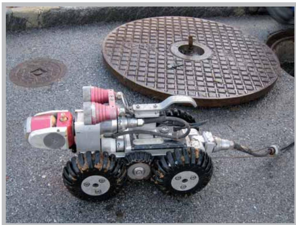
Robot-caméra servant à l'inspection des conduites d'égouts
